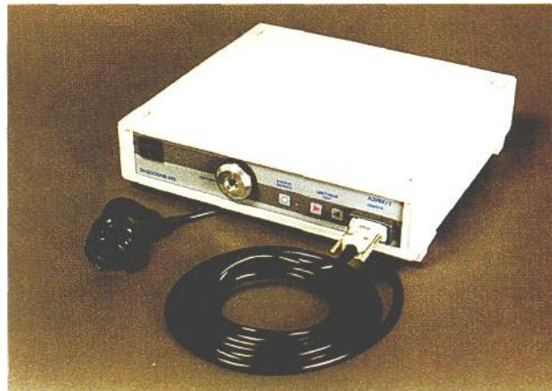
Рис. 30. Видеокамера, совмещённая с осветителем.
