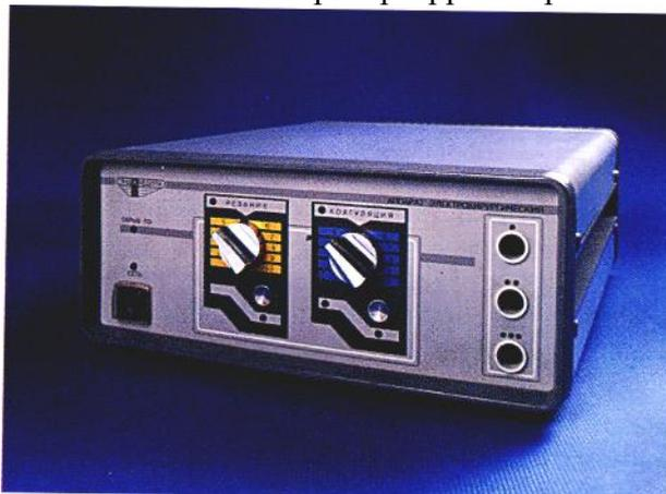
Рис. 33. Электрохирургический генератор.
