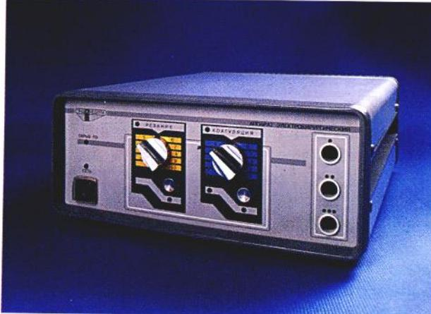
Рис. 33. Электрохирургический генератор.
